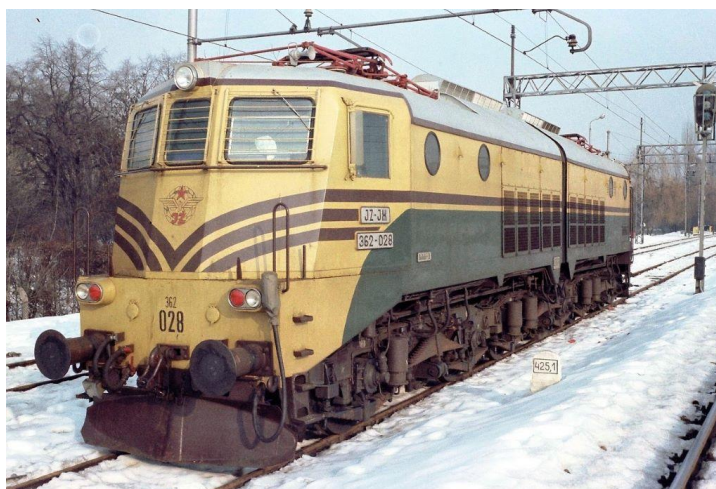
Že vidne številne modifikacije. Spremenjene luči, dodan reflektor, mreža na oknih, zaščitna stekla na stranskih oknih, večje bočne rešetke, grb ...
